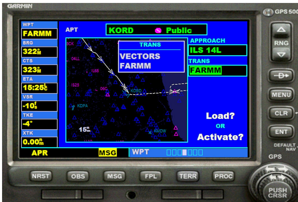
Image 10 – Activation de l’approche de la 14L de KORD, par la transition FARM
