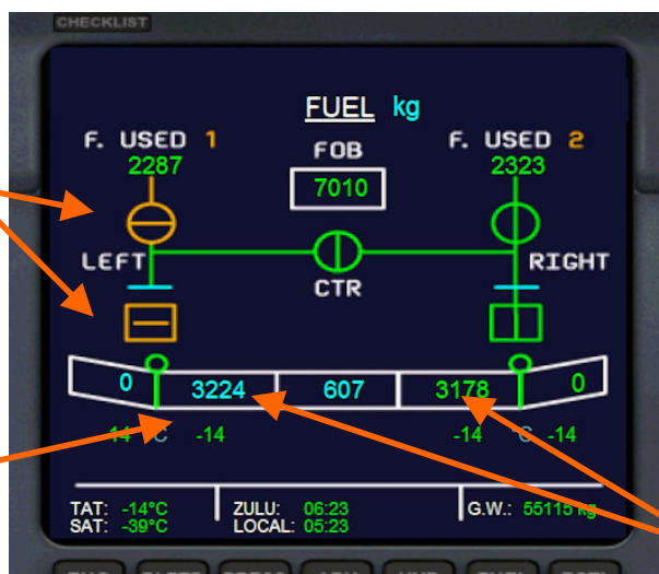
Image 37 –Panne avec alimentation par les réservoirs d'ailes
