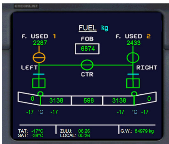
Image 40 – CROSSFEED ouverte avec les 2 pompes ! Tous les réservoirs sont ouverts
