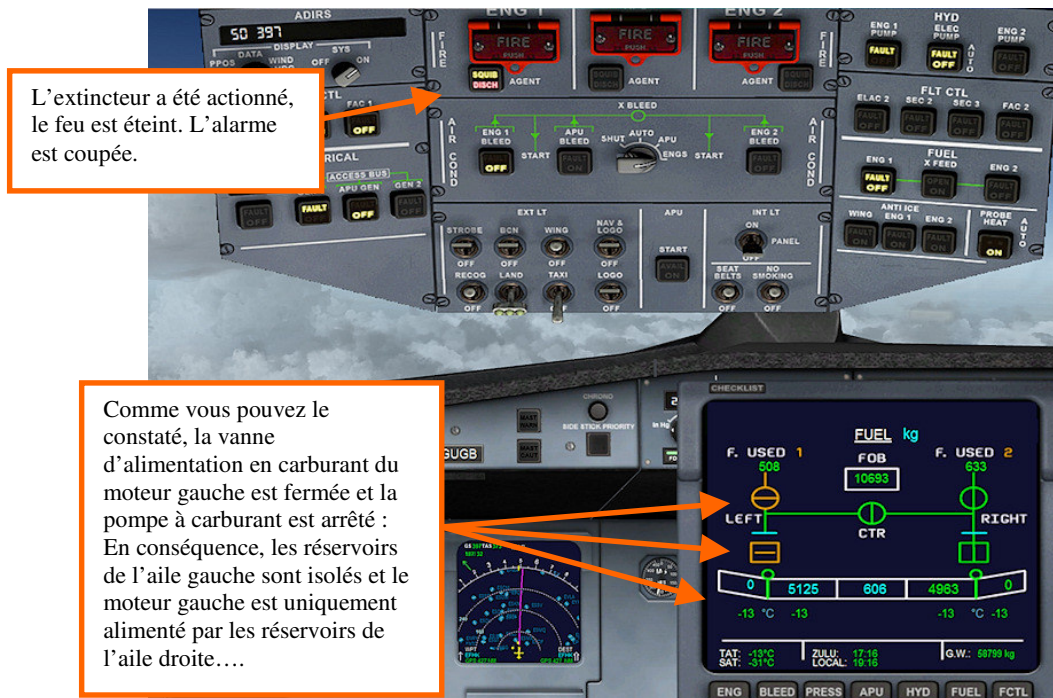
Image 75 – Le feu est éteint. Il va falloir gérer le circuit carburant afin d'éviter que l'avion se déséquilibre....
