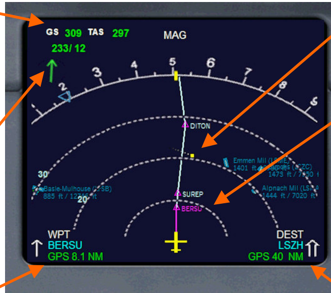
Image 4 - ND en mode ARC échelle 40 Nm
