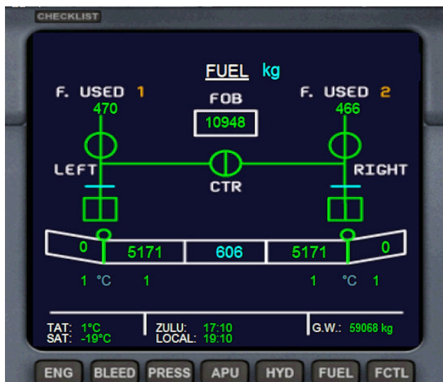
Image 36 – Alimentation par les réservoirs d'ailes
