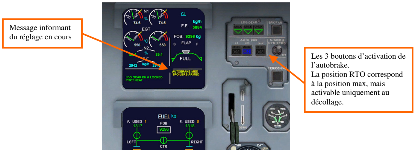
Image 59 – Commandes de l'Autobrake
