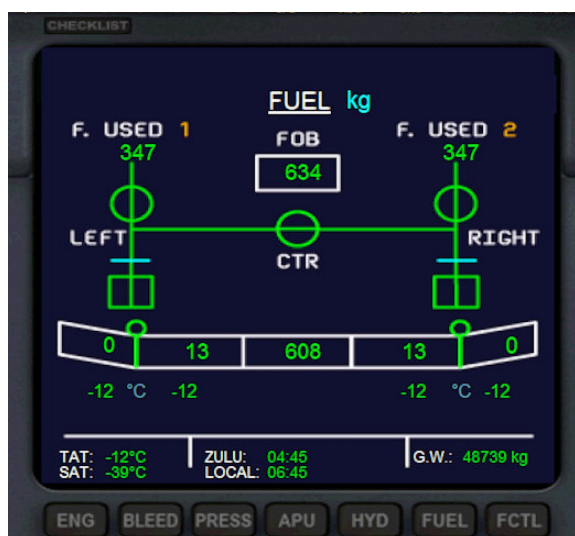
Image 41 – ouverture de la CROSSFEED en cas de niveau bas de carburant
