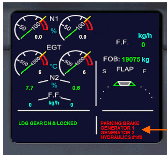
Image 19 – ECAM1 à la mise sous tension de l'avion
