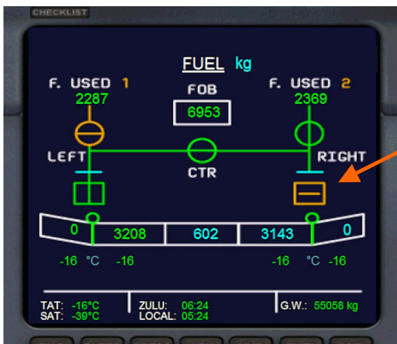
Image 39 – Alimentation croisée du moteur gauche via la CROSSFEED
