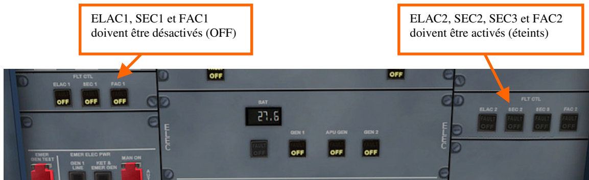
Image 68 – FBW en mode DIRECT LAW sur l’overhead en vue 3D dans le cockpit virtuel
