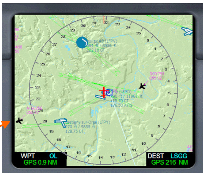
Image 17 – Fenêtre Popup du ND en mode Radar terrain
