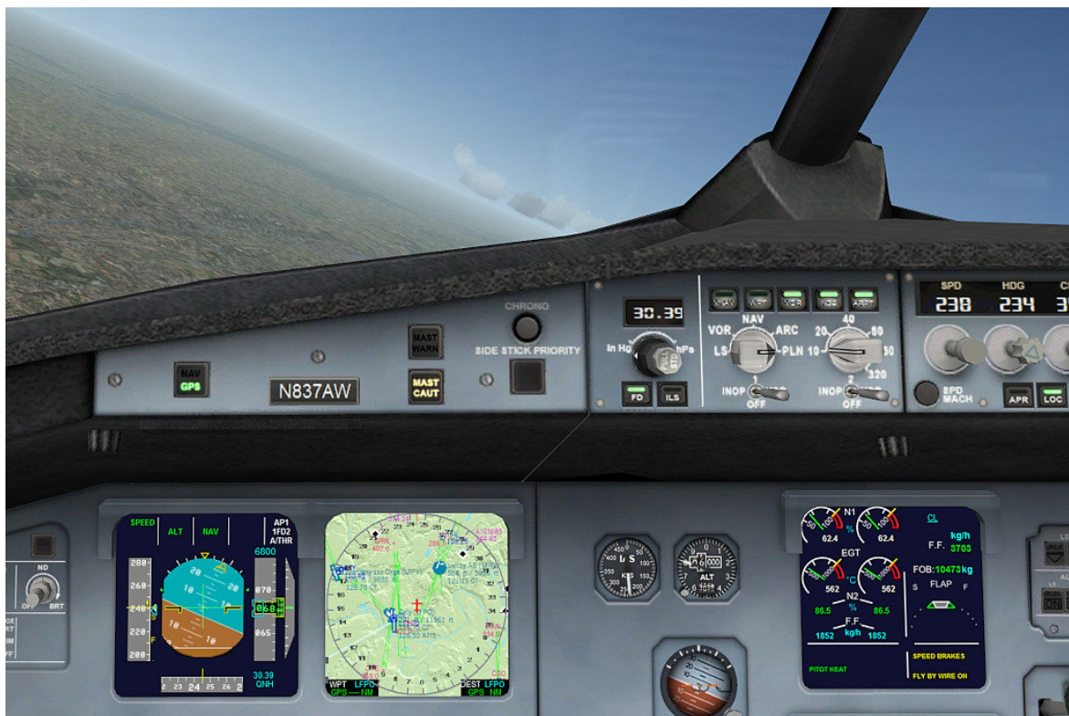
Image 16 – Affichage du Radar terrain sur le ND
