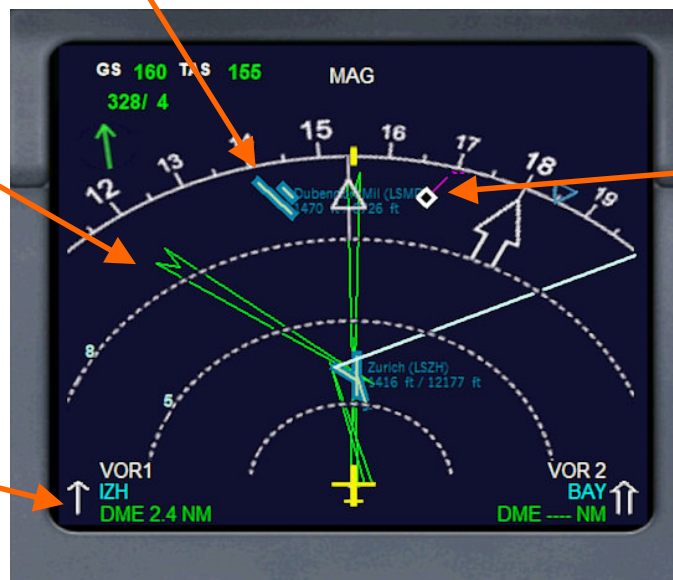
Image 5 - ND en mode ARC échelle 10 Nm
