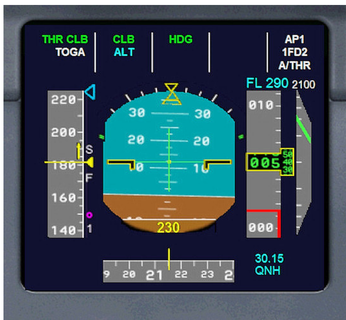
Image 63- L'avion vient de décoller, et à 175 kts, la VNAV vient d'enclencher le PA
