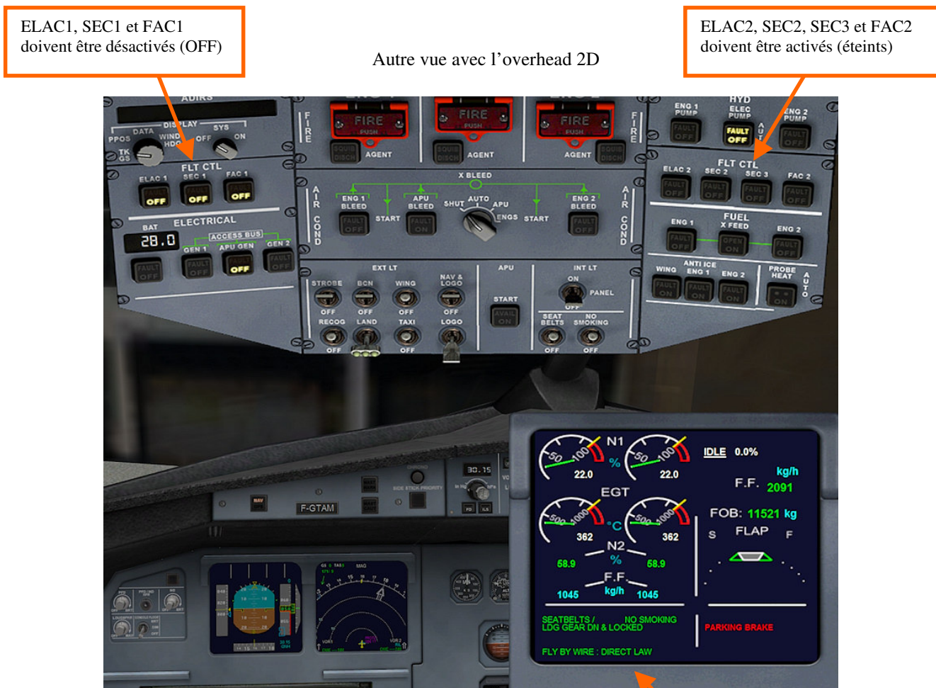
Image 69 – FBW en mode DIRECT LAW sur l’overhead en vue 2D et message sur l’ECAM-1
