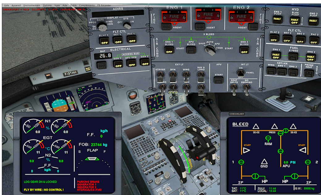
Image 43 – Mise sous tension du circuit électrique
