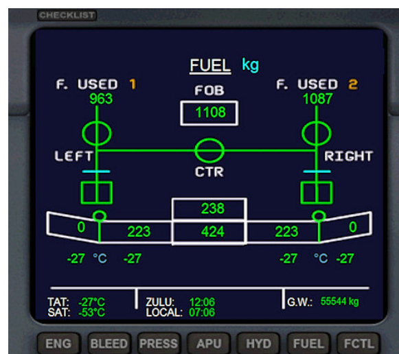
Image 41 – ouverture de la CROSSFEED en cas de niveau bas de carburant
