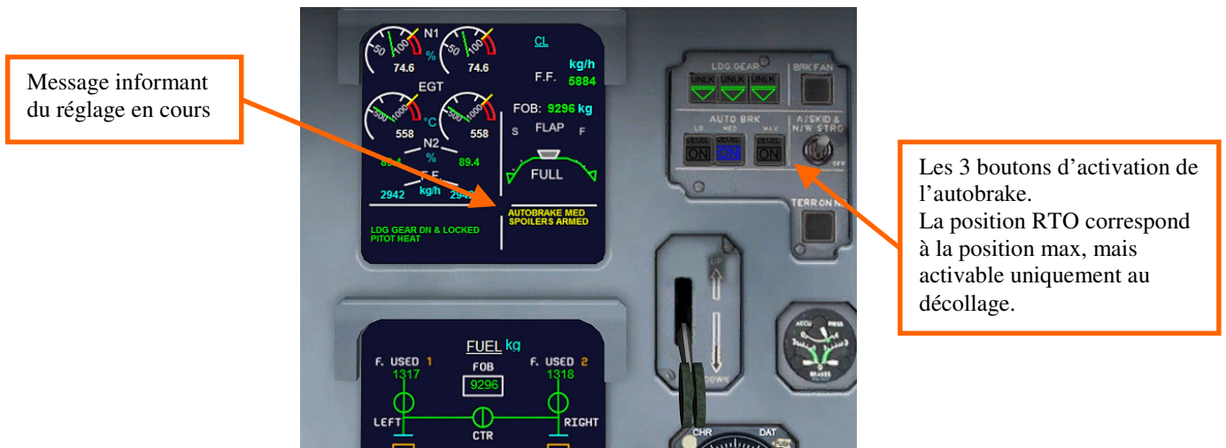
Image 59 – Commandes de l'Autobrake
