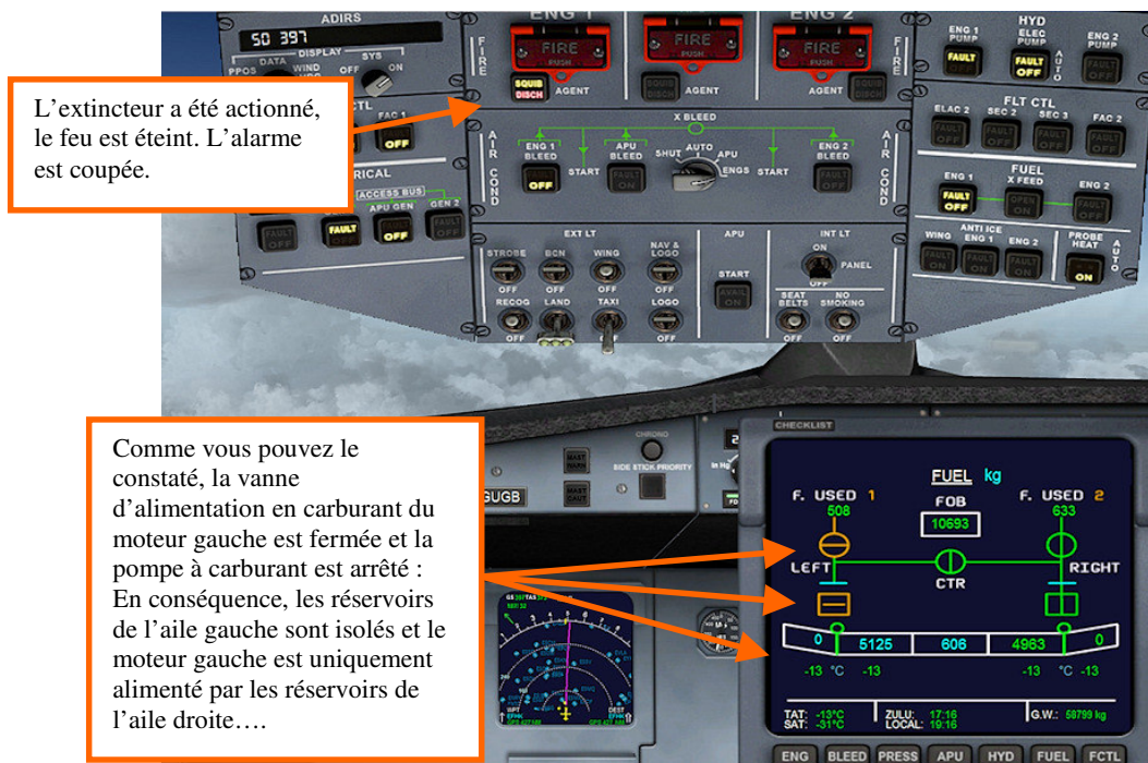
Image 75 – Le feu est éteint. Il va falloir gérer le circuit carburant afin d'éviter que l'avion se déséquilibre.... NOTA : Cette capture d'écran provient du A319 qui a un seul réservoir central.
