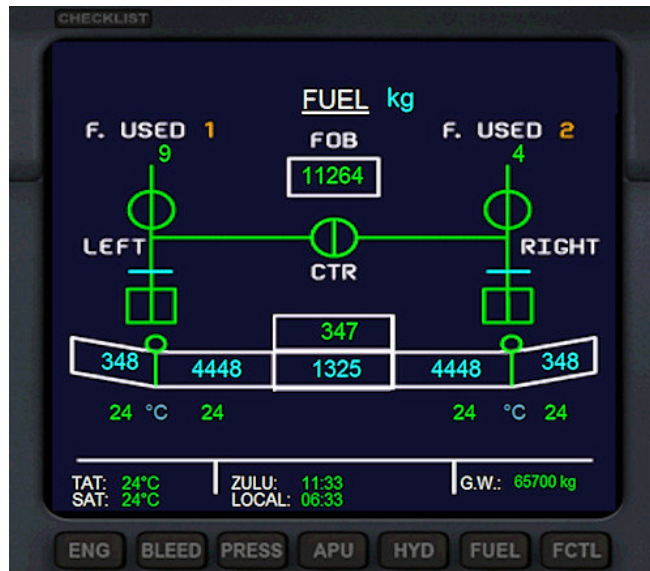
Image 35 – Réservoirs central en cours d'utilisation (affichage en kg)
