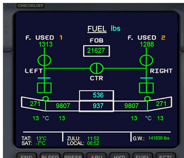
Image 36 – Alimentation par les réservoirs d'ailes
